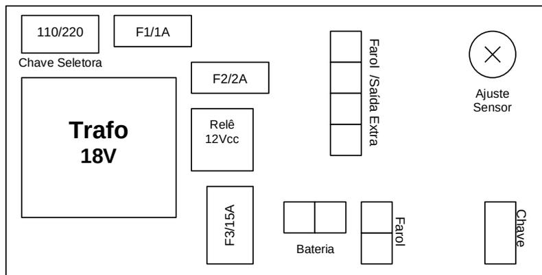
Obs.: Para ter acesso a Placa Eletrônica localizada na parte superior do Bloco, atrás dos faróis, somente retire a tampa metálica de proteção superior. Ela é encaixada sob pressão.
